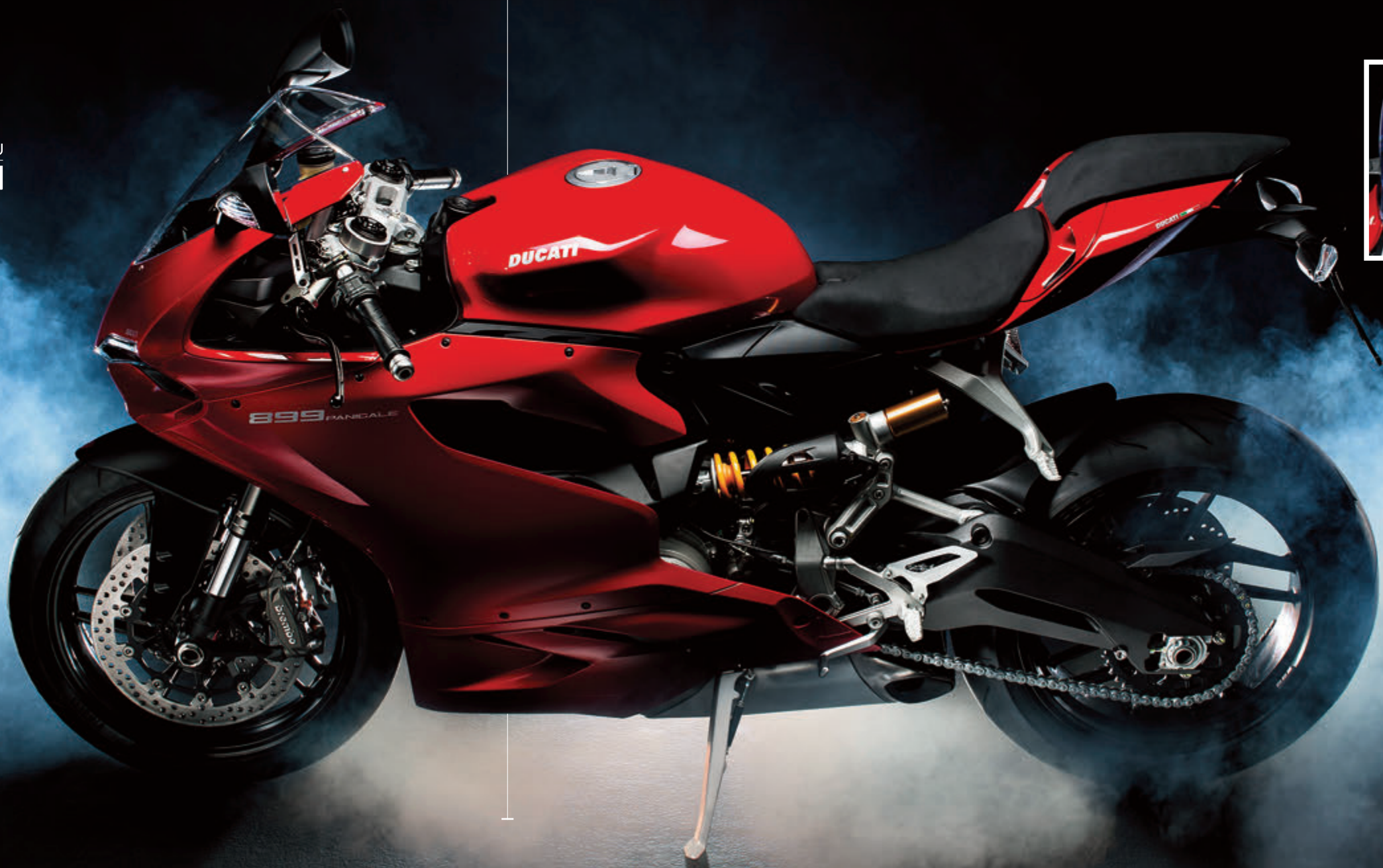
1 한국에 첫 출시된 슈퍼바이크 라인인 899 파니갈레는 디지털 디스플레이가 장착됐다. 2 148마력의 898cc 수랭식 L트윈 엔진과 직경 32cm의 거대한 트윈 디스크 브레이크(프런트가 장착됐다). 3, 4 두카티의 섹시함과 유머를 느끼게 하는 사진 두 장. 미국 포틀랜드의 모토코르사는 2012년 1199 파니갈레의 출시에 맞춰 (SEDUCTIVE)라는 화보집을 공개했다. 여기까지는 평범한 일이지만... 몇달 뒤에는 남자 직원들을 모델 삼아 똑같은 앵글로 촬영한 두 번째 화보집을 발표했다. 이름 하여 (MANIGALE)! 두 화보집의 유행어는 지금도 재공된다(motocorsa.com).
