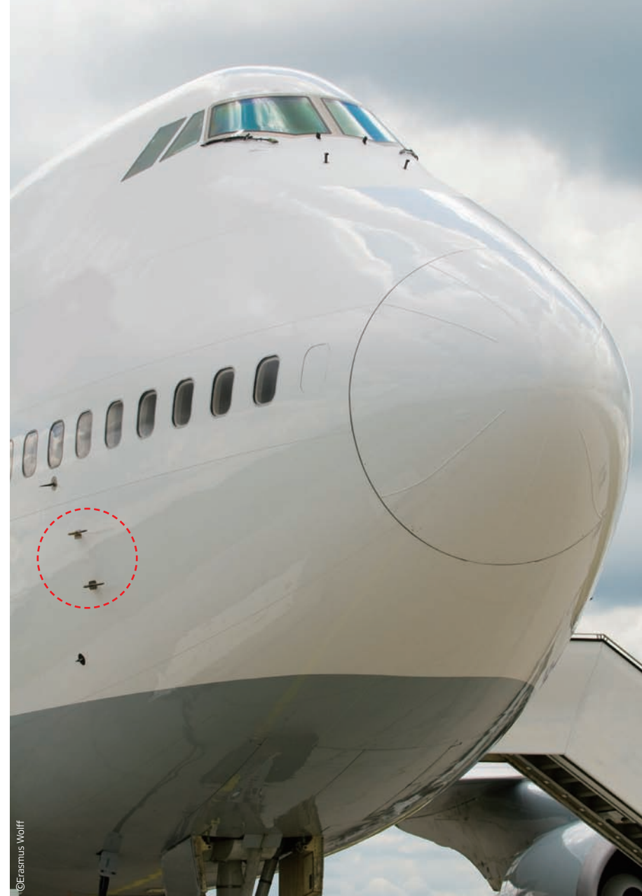
▲ 피토 관의 구조. 전진 방향의 옆으로 뚫린 구멍(정압관)과 앞으로 뚫린 구멍(동압관)으로 유입되는 공기의 압력차를 측정한다. ◀ 보잉 747 여객기의 피토 관.
