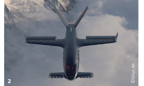
1 4인승의 시리우스 비즈니스 제트는 밀레니엄 제트보다 더 멀리 날아갈 수 있다. 2 시리우스 비즈니스 제트의 순항 모습. 두 모델 모두 날개에 소형 덕트 팬을 얹고 추력 방향을 조절하는 수직이착륙기다.
