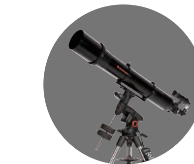
(위) 반사망원경은 굴절망원경보다 짧지만 경통 직경은 훨씬 크고, 접안렌즈가 경통 앞쪽에 달렸다. 셀레스트론의 초점거리 1000mm 보급형 제품. (아래) 원하는 천체를 향해 자동으로 망원경을 향하게 해주고 천체의 이동을 따라가는 적도에 굴절망원경을 올렸다. 적도에는 웬만한 입문용 굴절망원경보다 비싸다.
